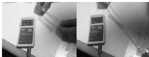
图 2 固化物低温弹性考察
