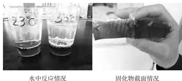
图 1 不同温度下材料水下固化情况
